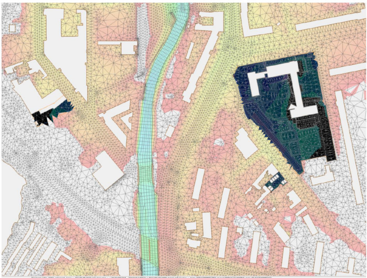
Abbildung 4-1 Ermittlung Retentionsvolumen Istzustand HQ(100)
