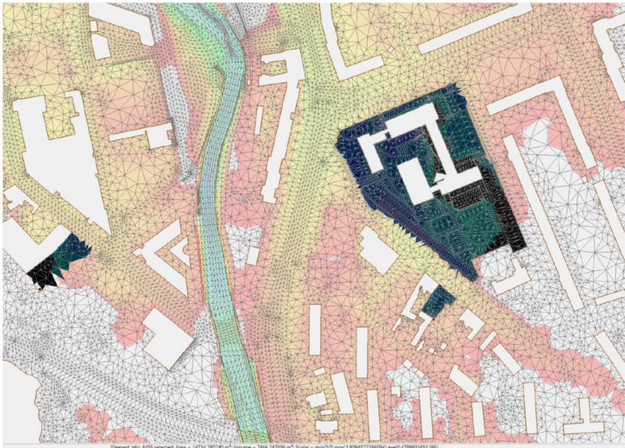
Abbildung 4-2 Retentionsvolumen Planzustand 0, Rechenlauf P-1 bei HQ(100)
