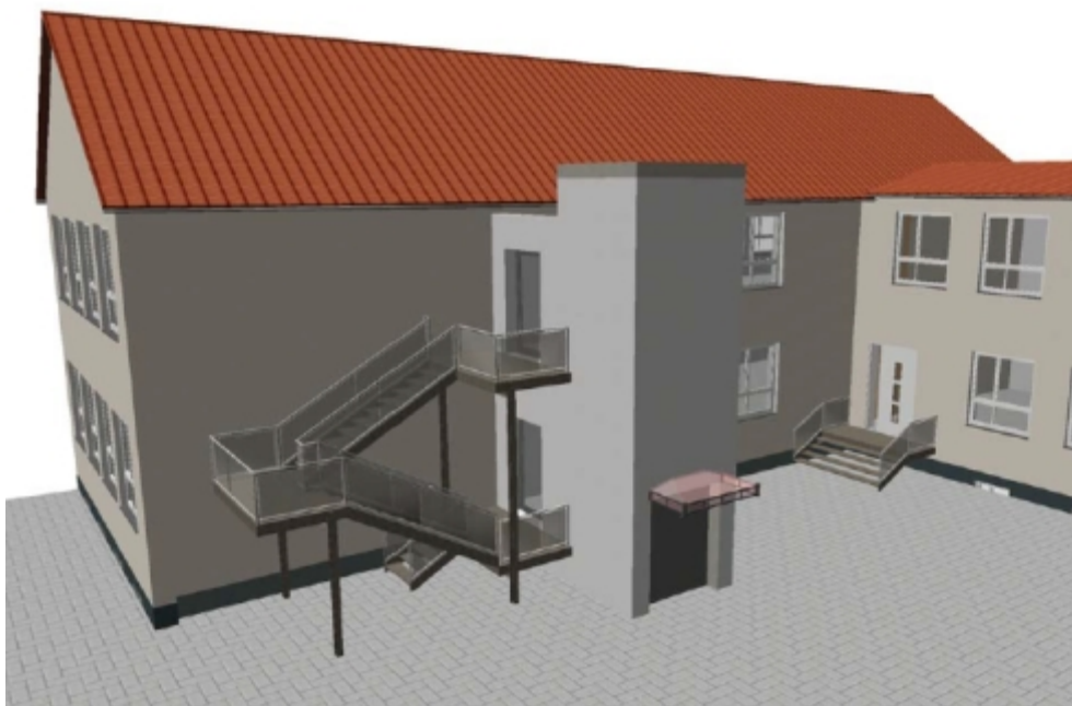
Auszug Ansicht - Anbau Aufzugsschacht / Fluchttreppe
