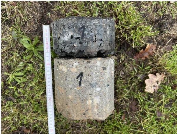
Abb. 1: Bohrkern BK 1, Betondicke 13 cm, Asphalt 7,5 cm
