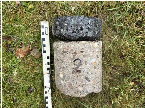
Abb. 2: Bohrkern BK 2, Betondicke 13,5 cm, Asphalt 5 cm
