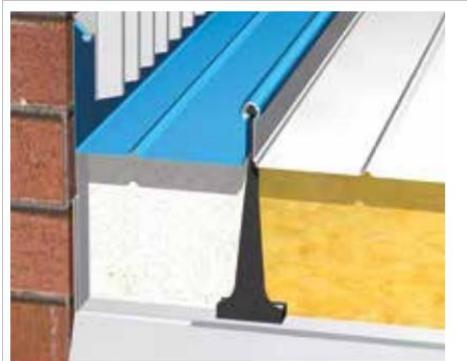
Anschluss der Aluminiumprofilbahn mit Kappleisten und Anschlussblech
