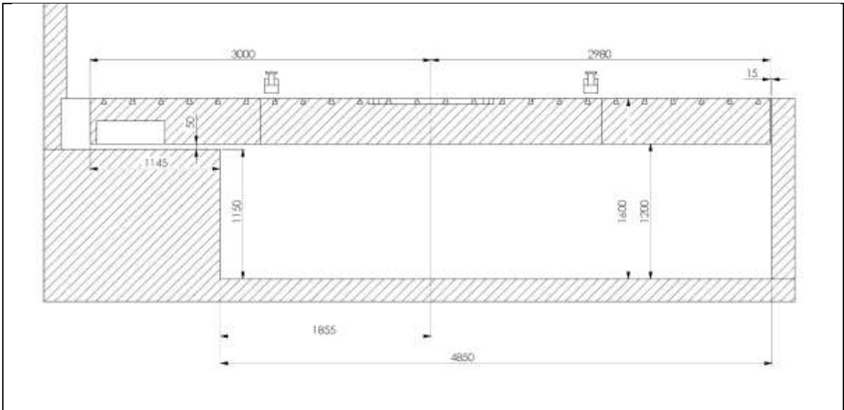
Abbildung 1-4 Schnitt der Prüfstandsgrube inkl. Aufspannplatte quer zur Längsachse
