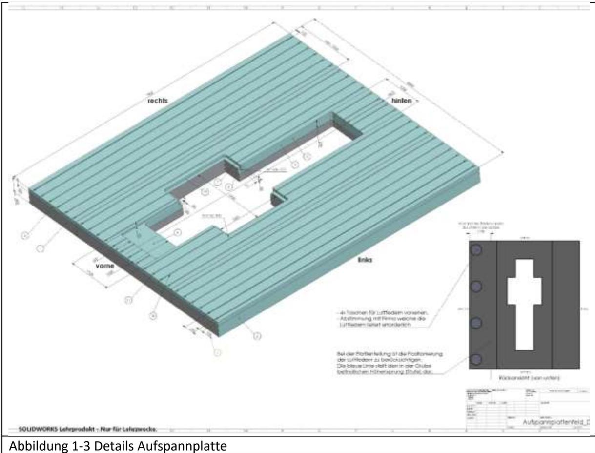
Abbildung 1-3 Details Aufspannplatte
