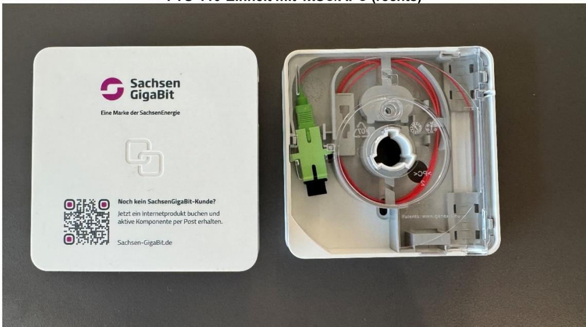
**Bild 36 – NE 3 links, NE 4 Rechts mit Verbindungsstück und Laserzeichen**
