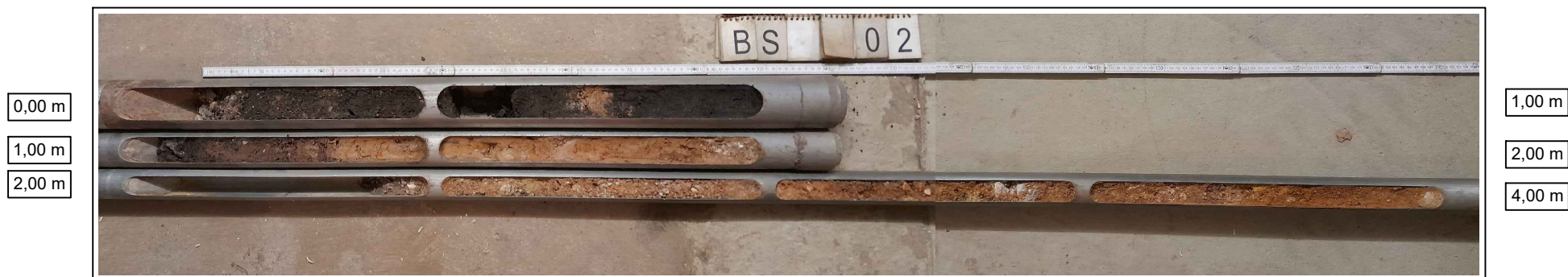
Bild 2: Bohrgut der Rammkernsondierung BS 02/24
