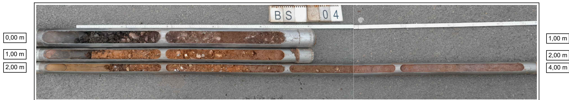
Bild 4: Bohrgut der Rammkernsondierung BS 04/24
