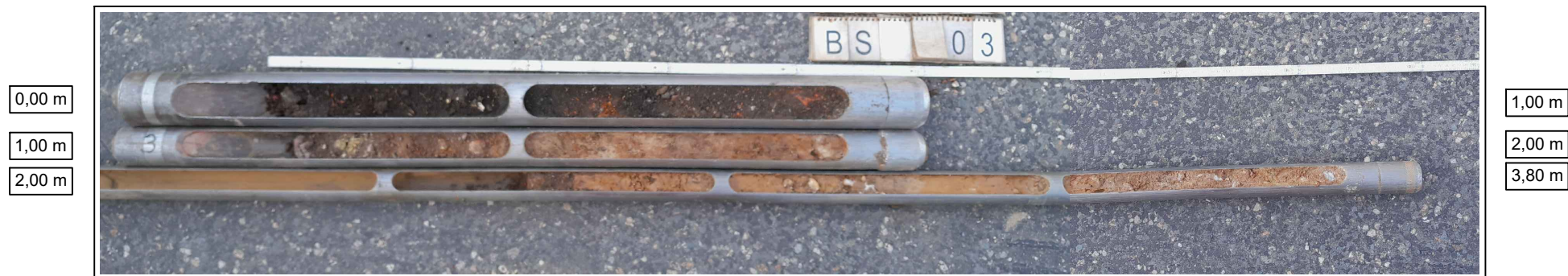
Bild 3: Bohrgut der Rammkernsondierung BS 03/24
