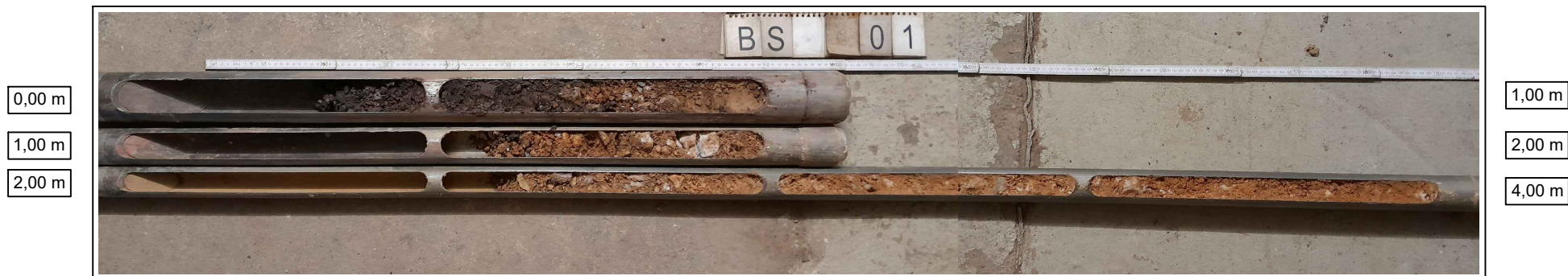
Bild 1: Bohrgut der Rammkernsondierung BS 01/24
