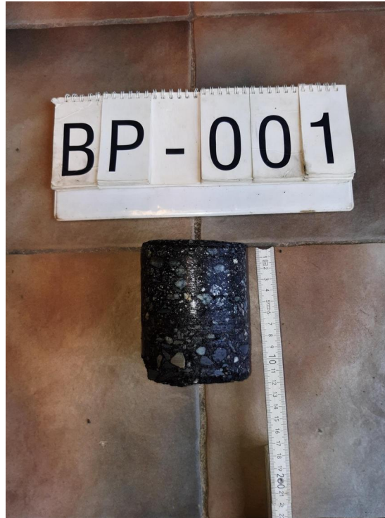
Foto 1: Asphaltbohrkern BP 1 (0,00...0,11 m)
