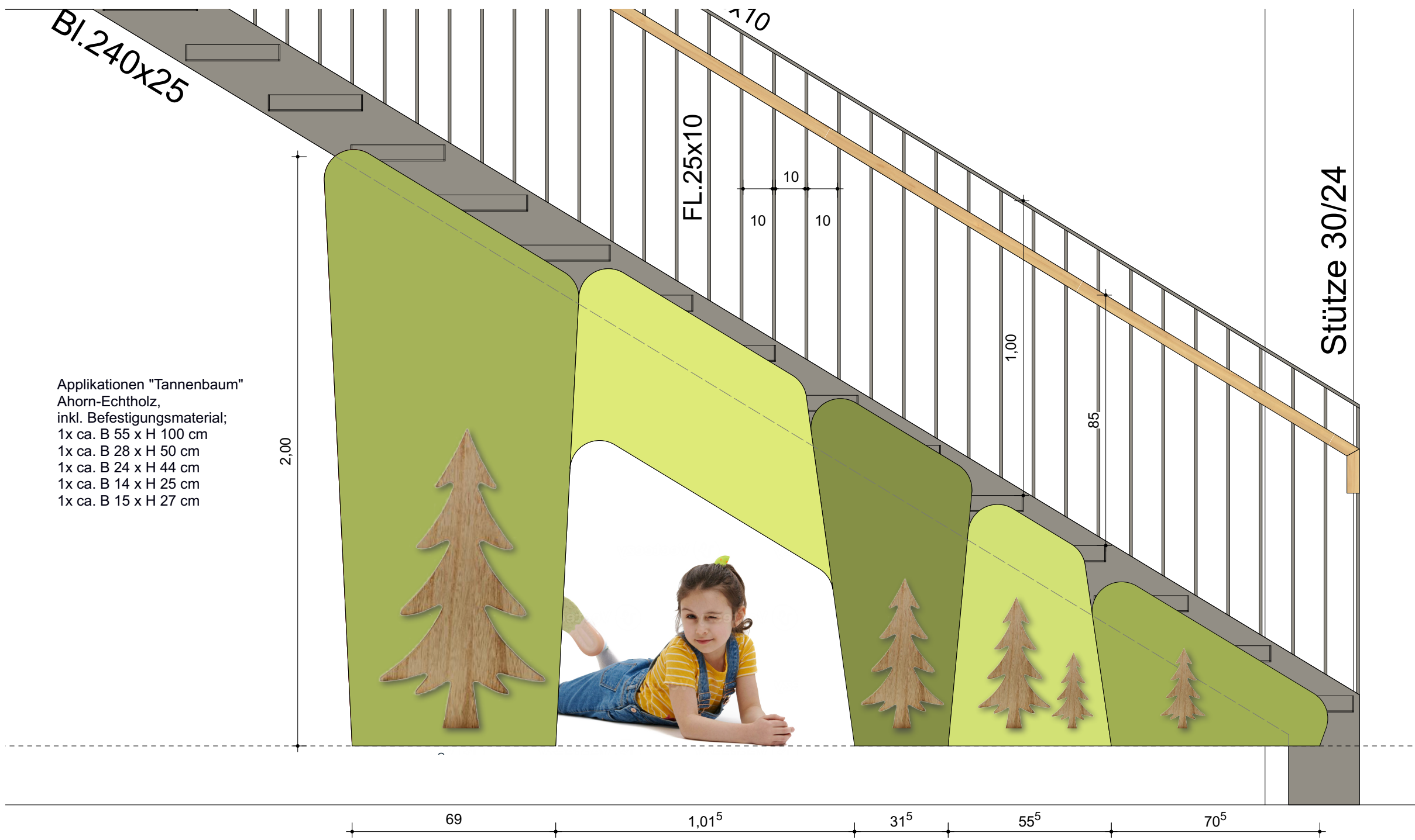
ANSICHT AUSFÜHRUNG UNTERLAUFSCHUTZ TREPPE (beideseitig) M 1:15
