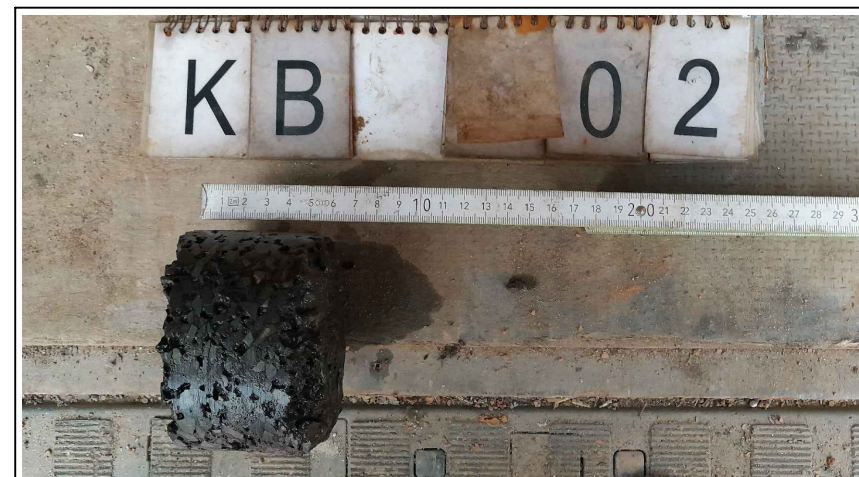
Bild 6: Bohrgut der Kernbohrung KB 02/24
