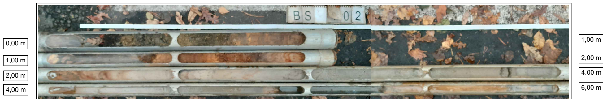
Bild 2: Bohrgut der Rammkernsondierung BS 02/24
