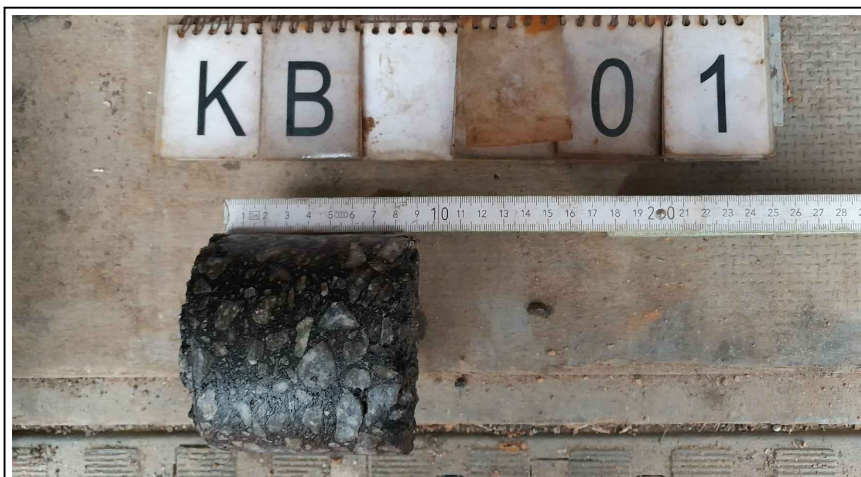
Bild 5: Bohrgut der Kernbohrung KB 01/24
