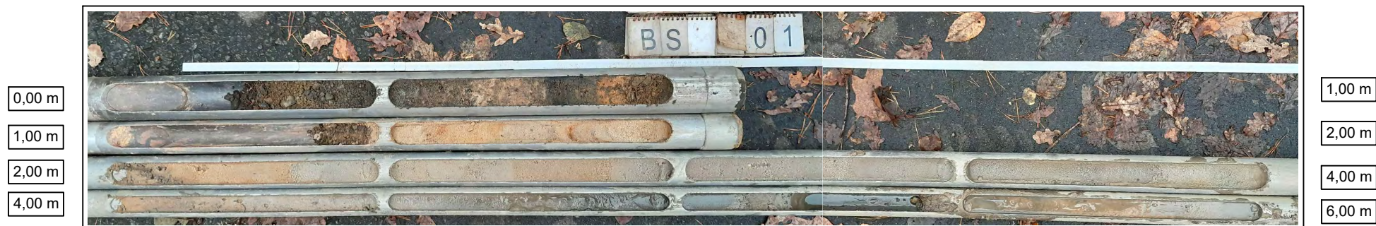
Bild 1: Bohrgut der Rammkernsondierung BS 01/24
