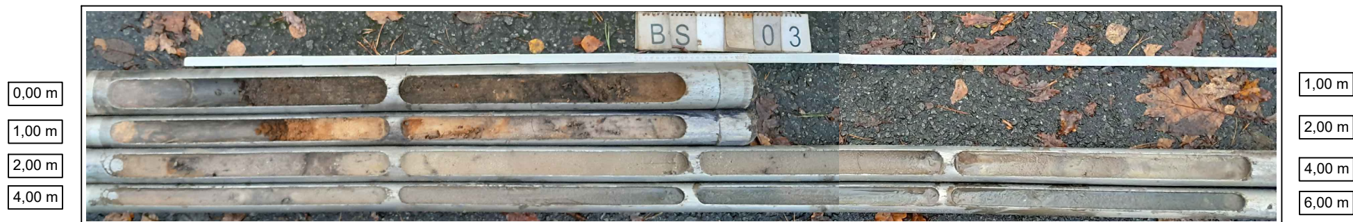
Bild 3: Bohrgut der Rammkernsondierung BS 03/24
