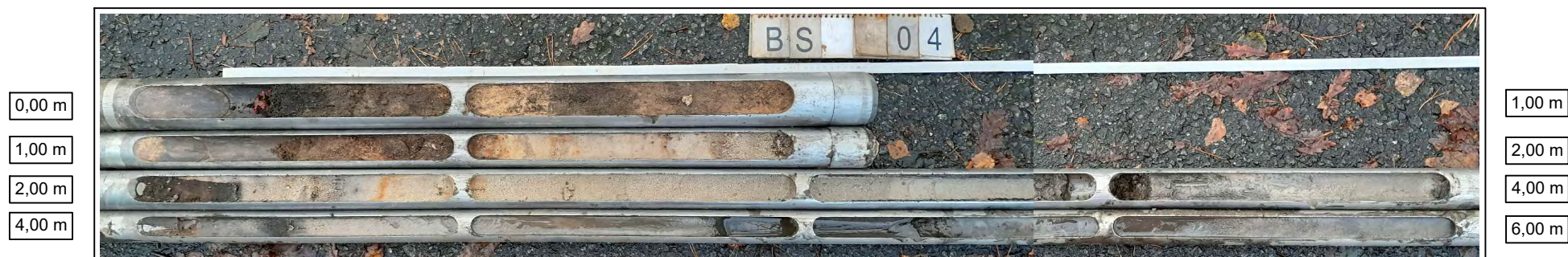
Bild 4: Bohrgut der Rammkernsondierung BS 04/24
