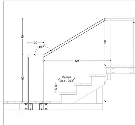
Schnittansicht: Handlauf am Treppenmodul M4.1 M1:20
