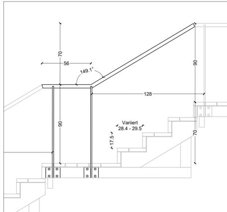
Schnittansicht: Handlauf am Treppenmodul M4 M1:20
