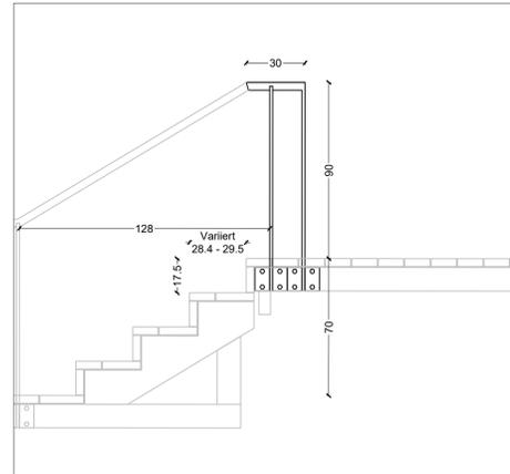
Schnittansicht: Handlauf am Treppenmodul M5.1 M1:20
