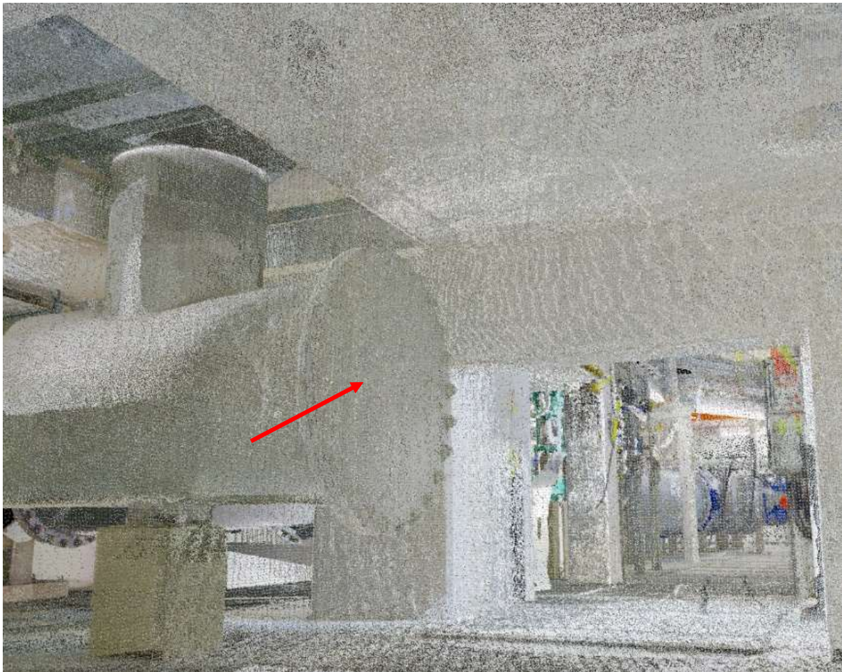
Abbildung 2 Screenshot 3D-Scan – Anschlussflansch Spülwasser
