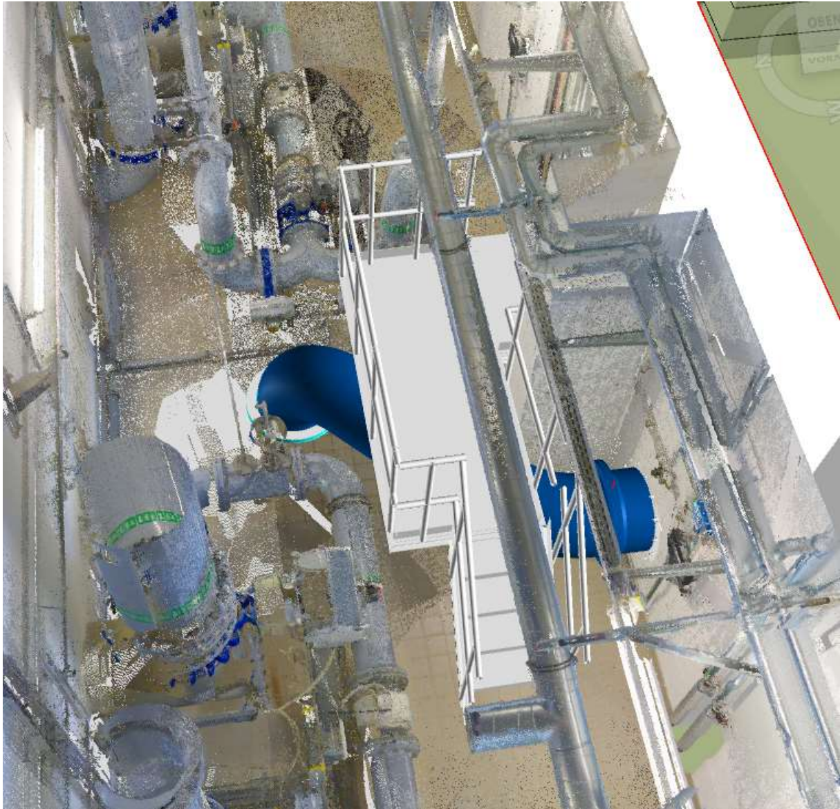
ABBILDUNG 9 AUSSCHNITT EINBINDUNG REINWASSERLEITUNG 3D-MODELL BV
