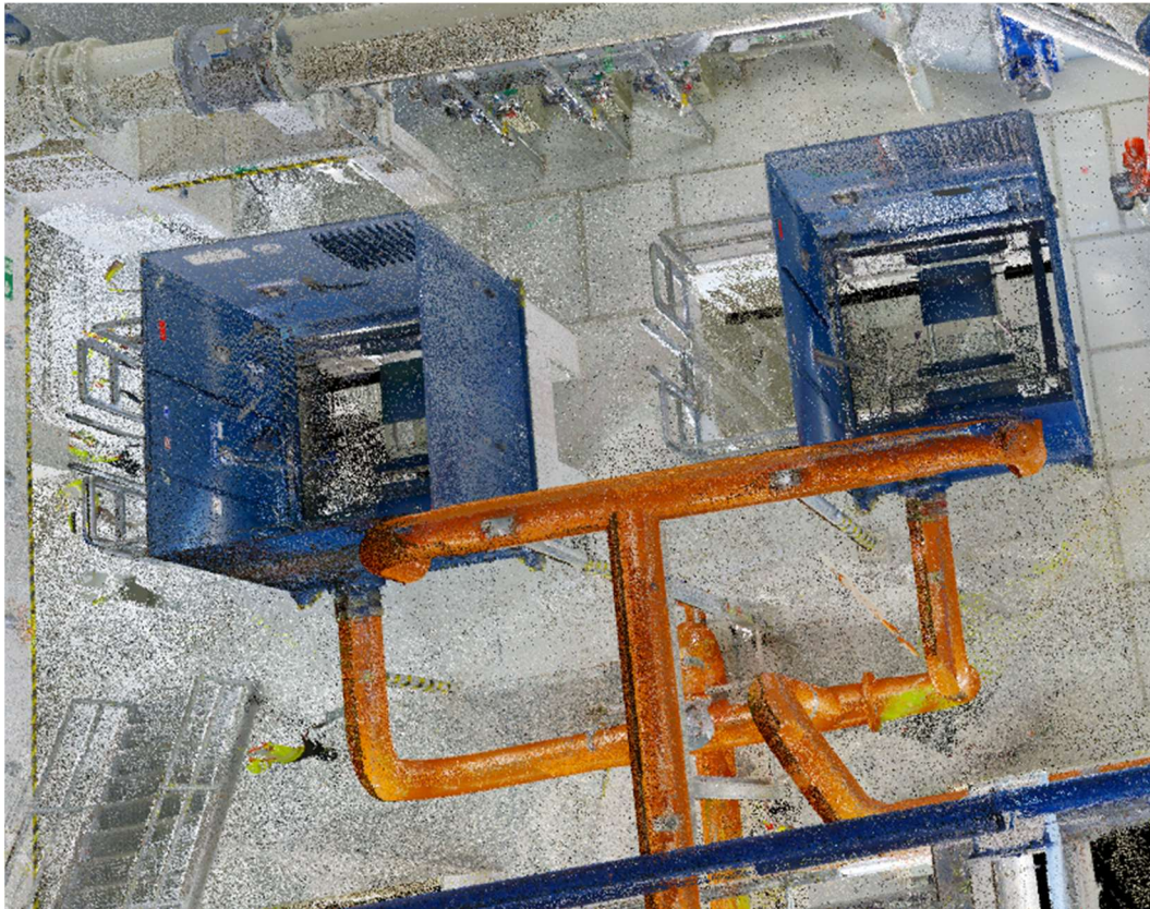
ABBILDUNG 5 SCREENSHOT 3D-SCAN –SPÜLLUFTGEBLÄSE
