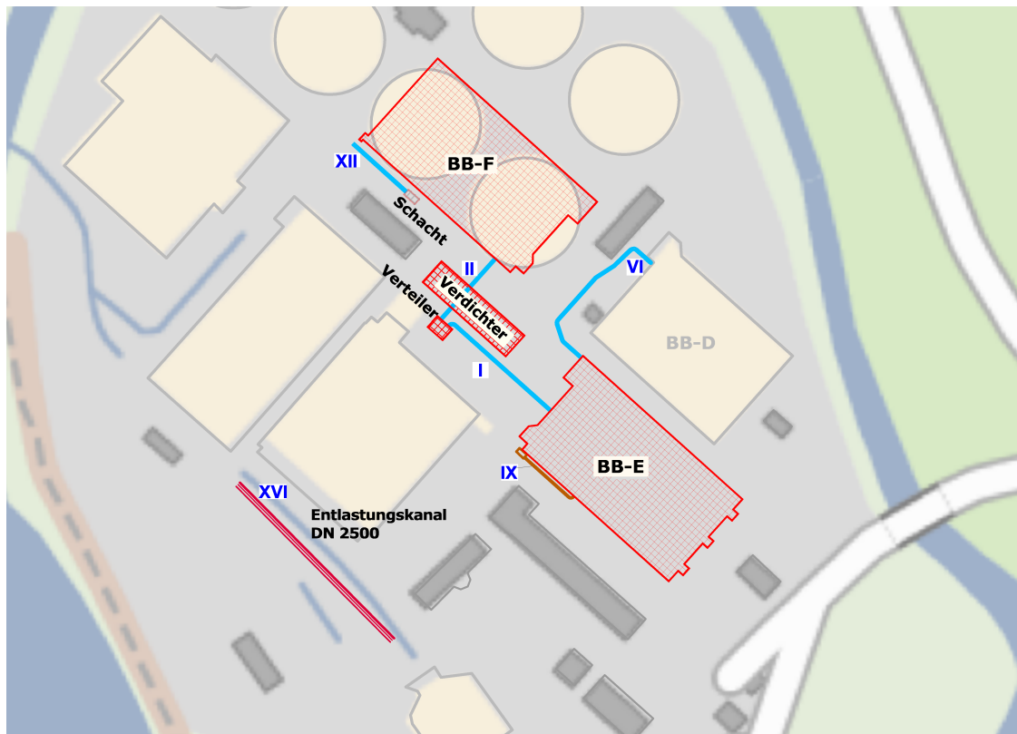
Abbildung 1: Darstellung der Lage der Bauwerke und Leitungen, für die Wasserhaltungen zu betreiben sind
