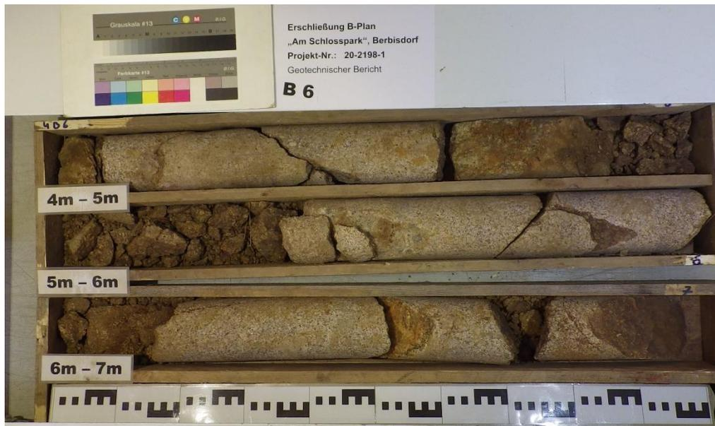
**Bild 7:** Bohrung B 2/20, 4 m – 7 m
