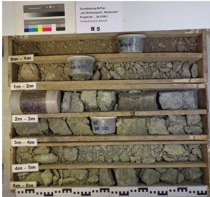
**Bild 5:** Bohrung B 5/20, 0 m – 6 m
