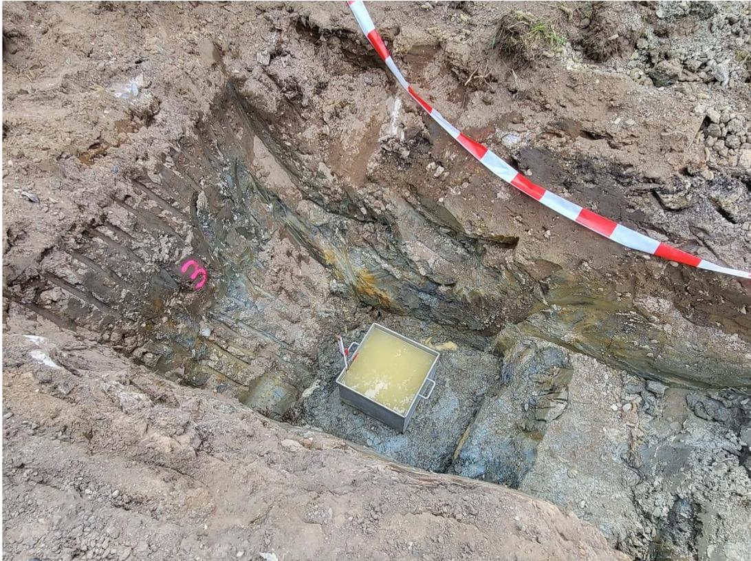
Bild 11: Versickerungsversuch im Baggerschurf Sch 3/23
