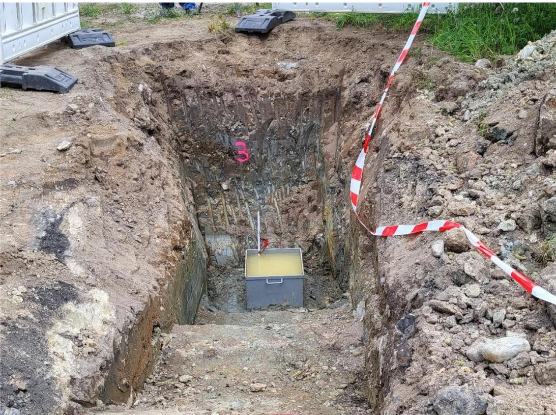
Bild 10: Versickerungsversuch im Baggerschurf Sch 3/23
