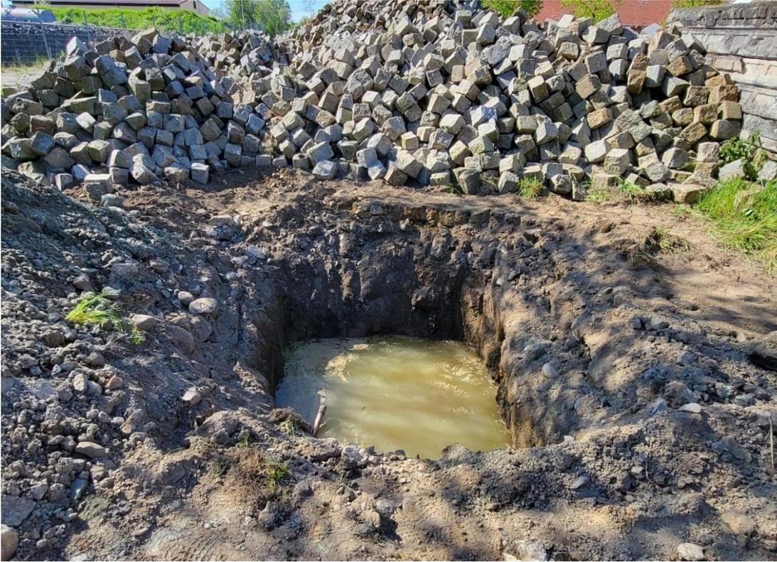
Bild 9: Mit Wasser gefüllter Baggerschurf Sch 2/23
