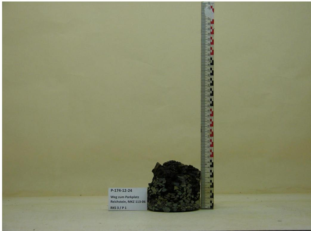
Bild 3: Asphaltbohrkern RKS 3
