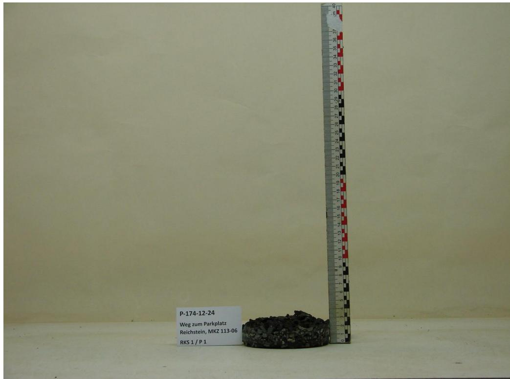
Bild 1: Asphaltbohrkern RKS 1
