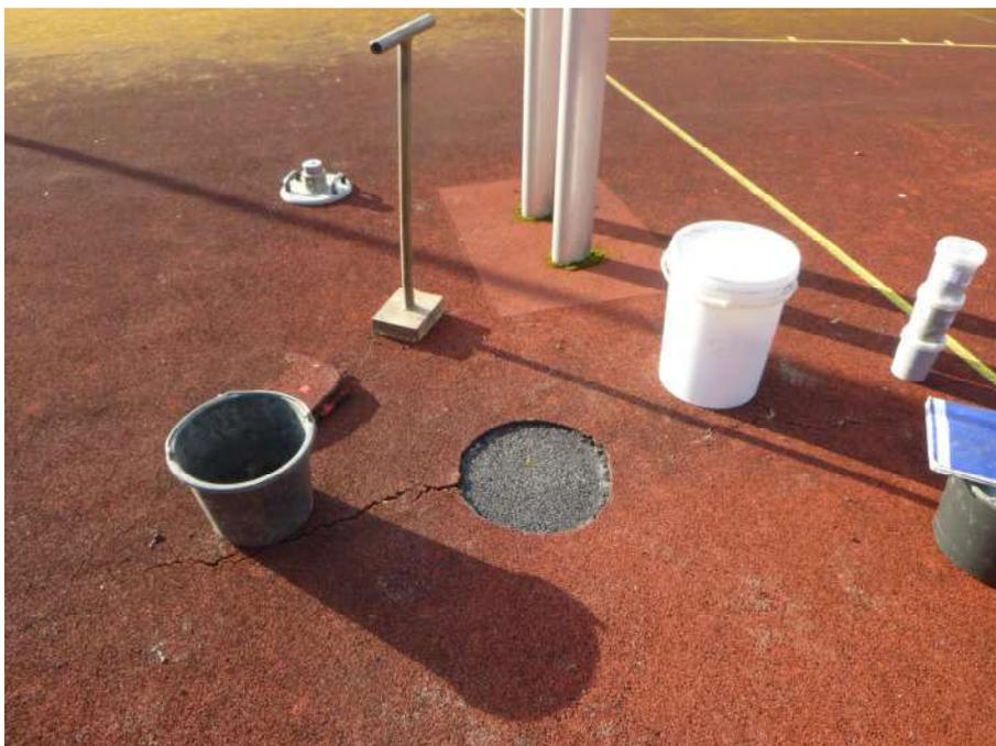
Foto 8: Kunststoffbelag und Asphalt Schurf S 1
