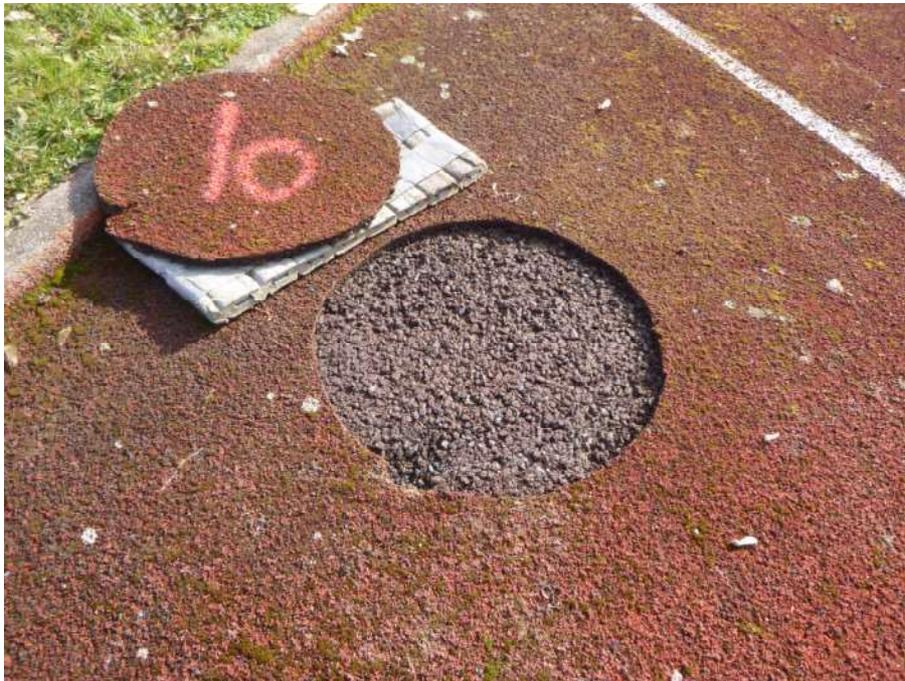
Foto 9: Kunststoffbelag und Asphalt Schurf S 2
