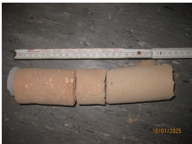
Abb. 1: BV „Neues Rathaus Dresden“. Bohrkern BK -1/W1, 16.01.2025
