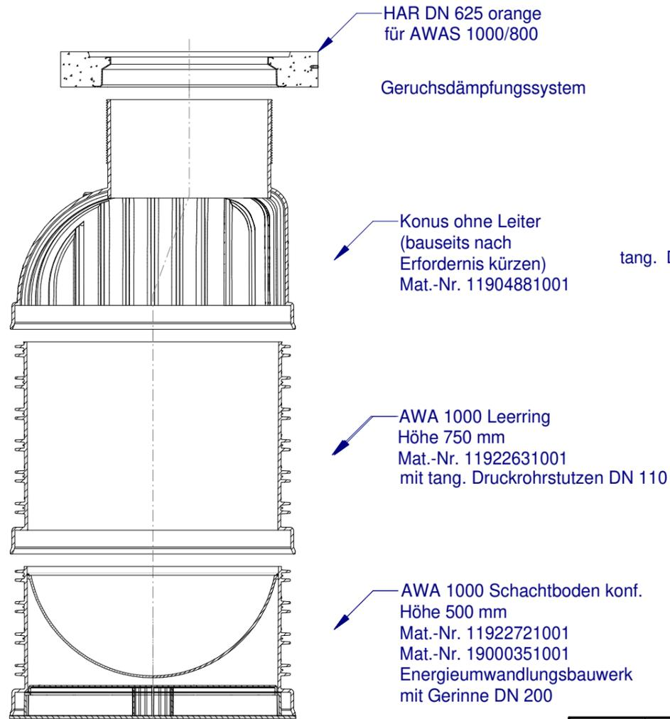
Verbindung der ankommenden Druckleitung aus PE-HD mit Druckrohrstutzen am Schacht für DA 110 mittels Plasson-Kupplung
