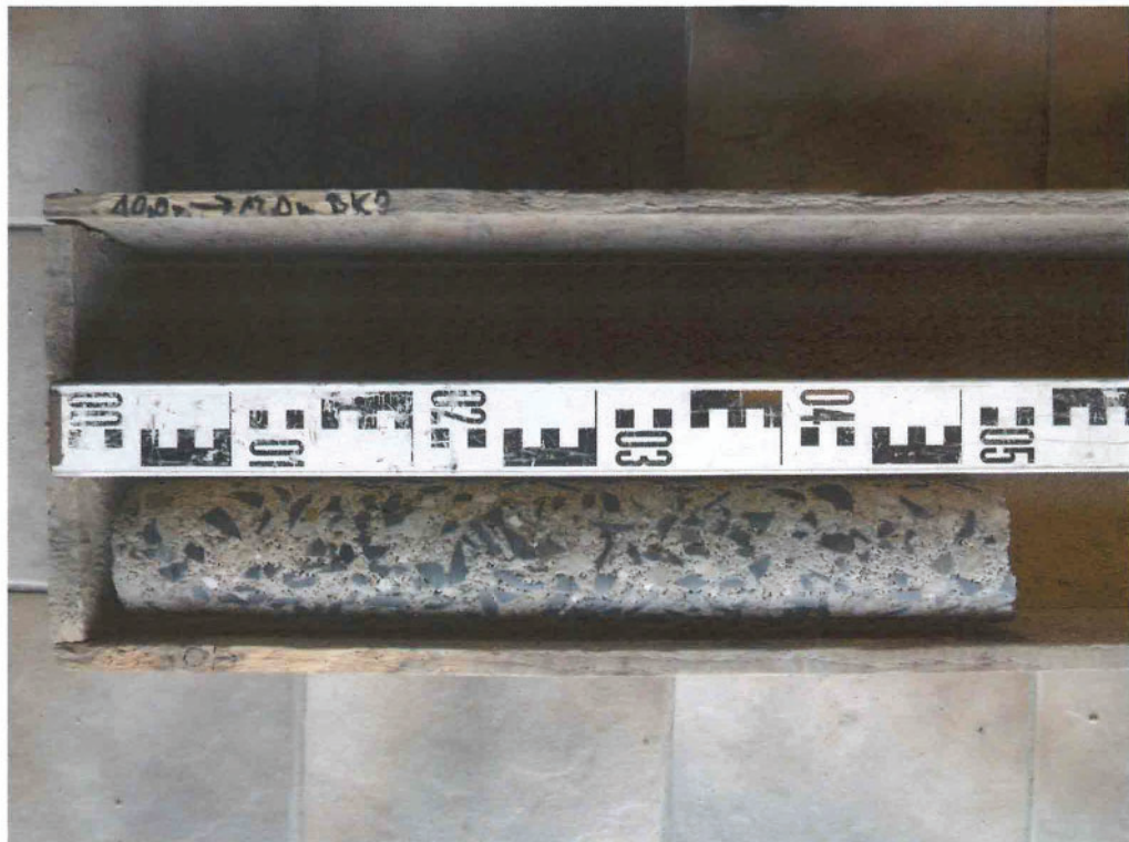
Bild 3. Bohrkern SB 3 (Widerlager)
