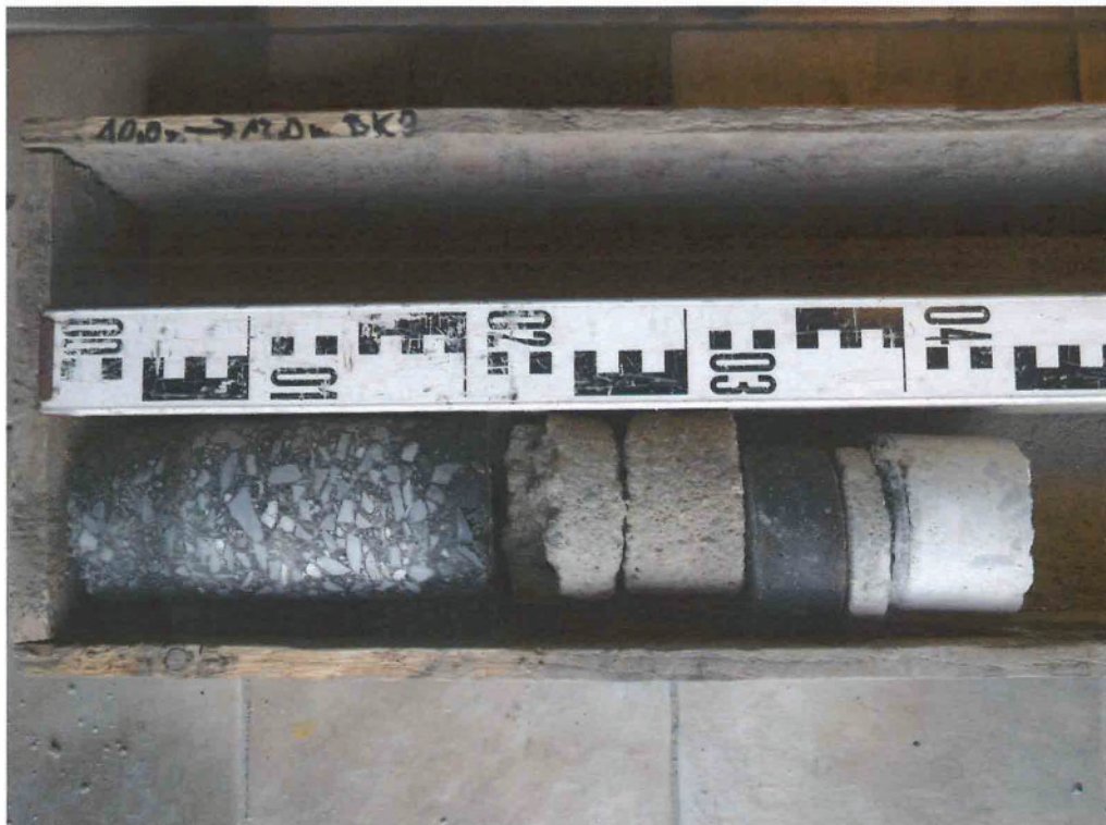
Bild 1. Bohrkern SB 1 (Überbau)
