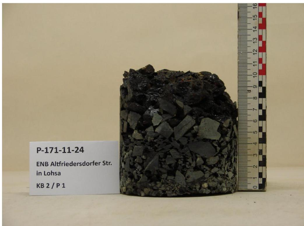
Bild 2: Asphaltbohrkern KB 2
