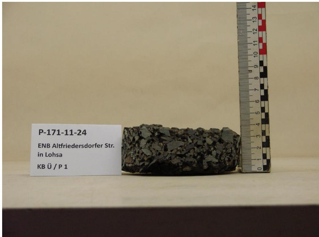
Bild 1: Asphaltbohrkern KB Ü
