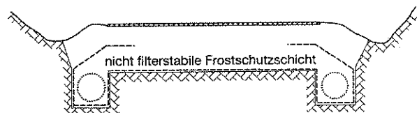
Bild 15: Trenn- und Filterschicht bei einer zum Untergrund nicht filterstabilen Frostschutzschicht (Planumssickerschicht), die hochstehendes Grundwasser unter die Unterkante der Frostschutzschicht absenken soll (RAS-Ew)
