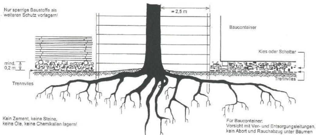
**Bild 3 Wurzeltellerschutz und Stammschutz mit Schutzmanschetten**
