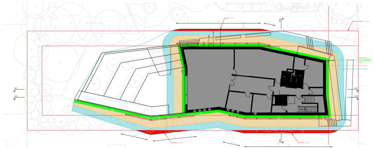
Im Grundriss ist nun dargestellt, wo die Außenkante bzw. Böschungskante einer mit 45° geböschten Baugrube enden würde. Hier ist klar zu erkennen, dass man auf den Längsseiten mit der Böschungskante sogar im Bereich des Nachbargrundstücks landet. Hier muss ein Vorgehen gefunden werden, wie die Baugrube kostengünstig und effizient hergestellt werden kann. (orange, 60°, blau 45°, rot Nachbargrundstück)
