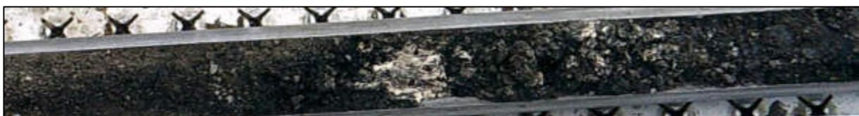
Bild 4: schwarzgraue, unsortierte Auffüllung in der Bohrsonde RKS 5
