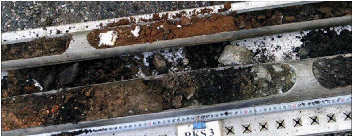
Bild 5: unsortierte Auffüllung mit Ziegelbruch und Gips in der Bohrsonde RKS 3
