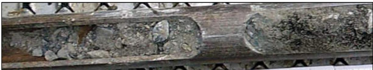
Bild 3: Schotter in der Sonde der RKS 1
