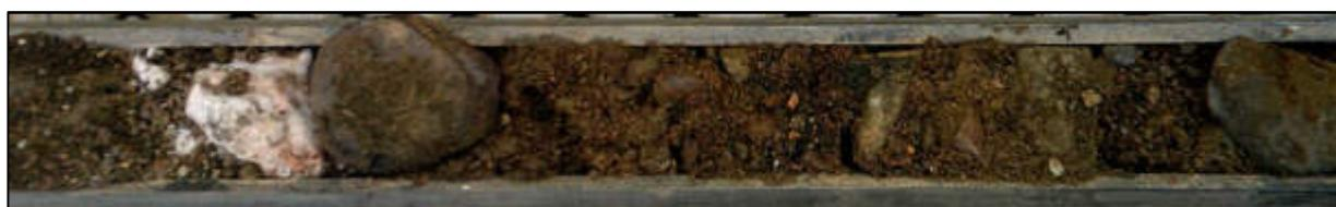
Bild 6: sandiger Bachschotter mit Quarzit und gerundeten Kiesen in der Bohrsonde der RKS 2
