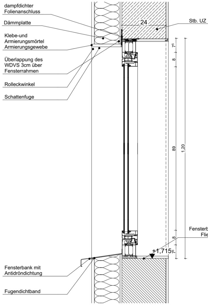
Vertikalschnitt M 1\_10
