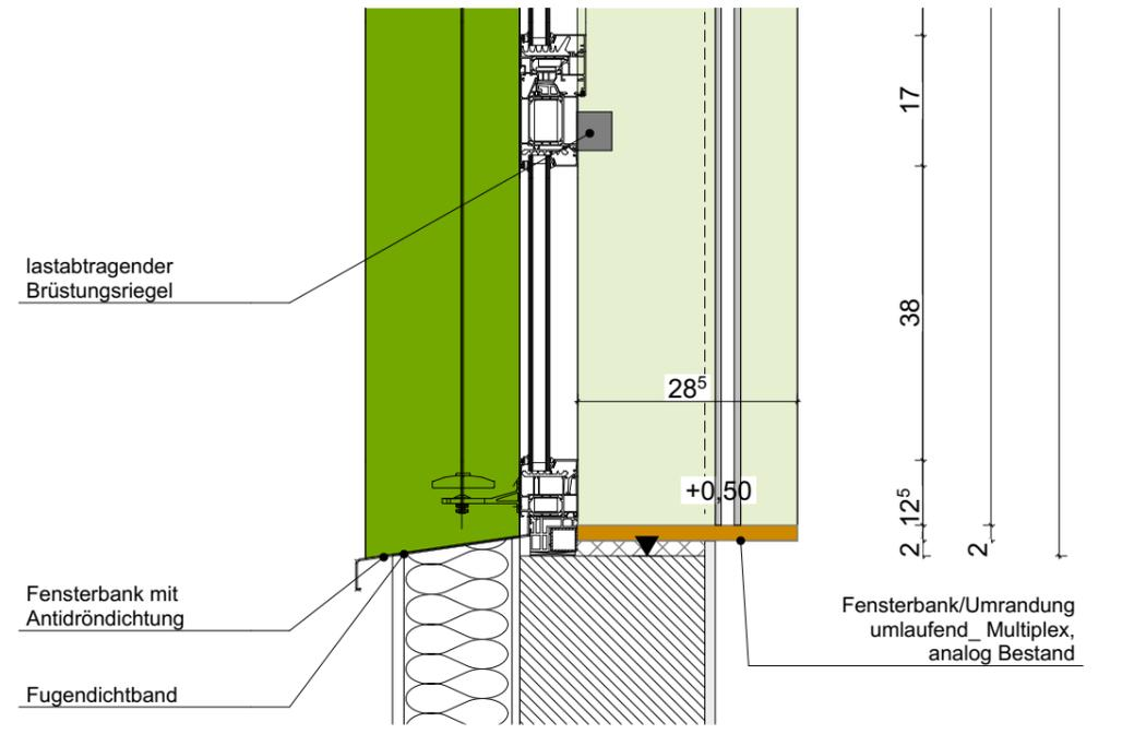
Vertikalschnitt M 1\_10
