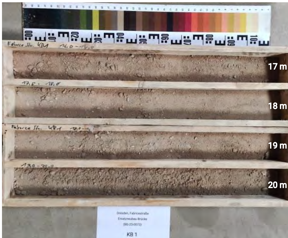
Abb. 5: Bohrkernaufnahme - KB 1 (2024) (16,0 - 20,0 m)
