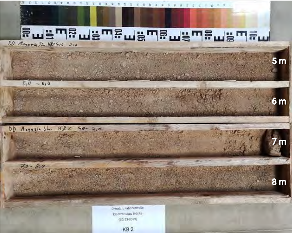
Abb. 7: Bohrkernaufnahme - KB 2 (2024) (4,0 - 8,0 m)
