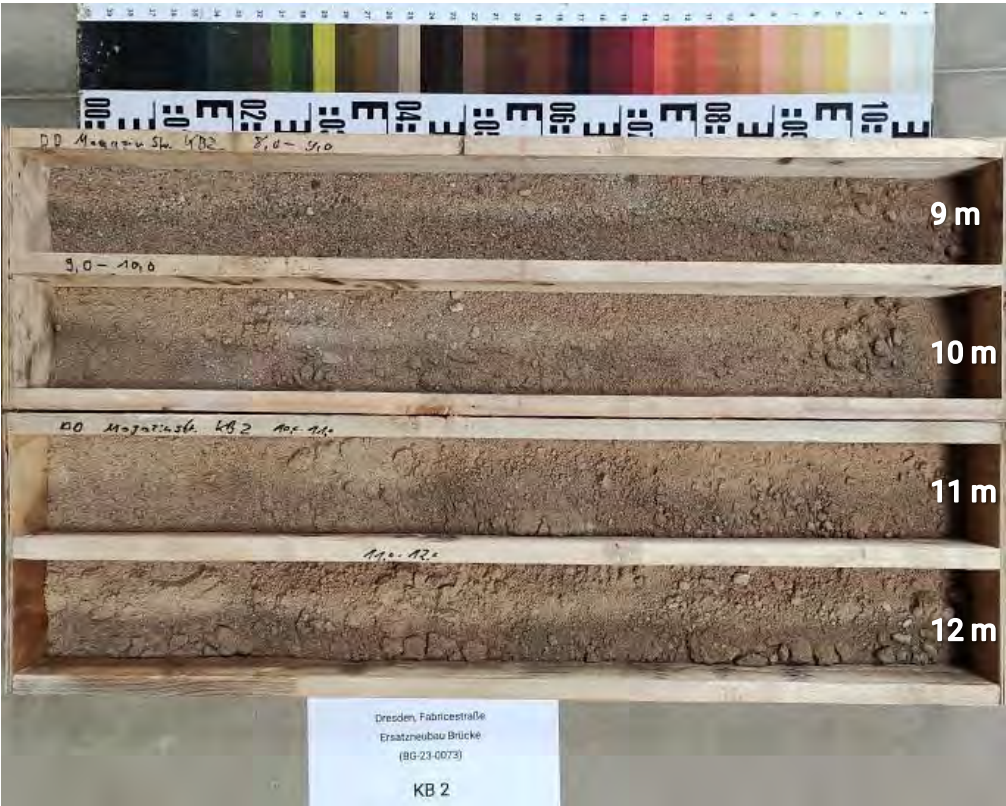
Abb. 8: Bohrkernaufnahme - KB 2 (2024) (8,0 - 12,0 m)
