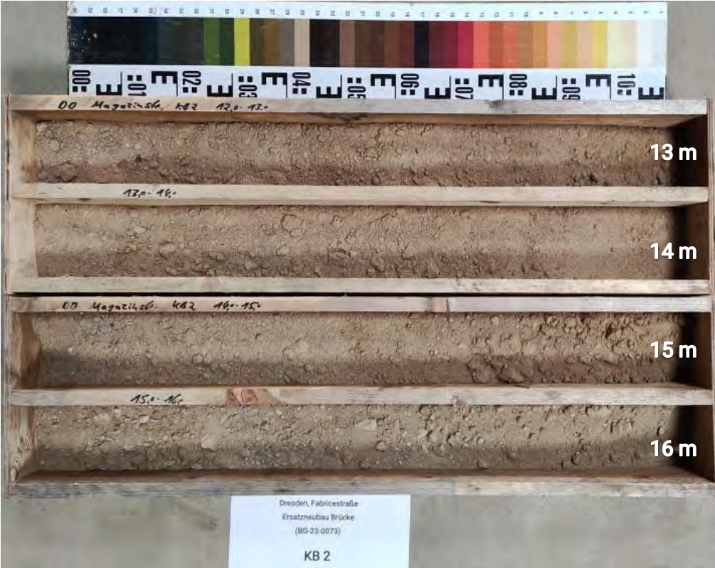
Abb. 9: Bohrkernaufnahme - KB 2 (2024) (12,0 - 16,0 m)
