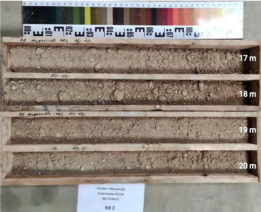
Abb. 10: Bohrkernaufnahme - KB 2 (2024) (16,0 - 20,0 m)
