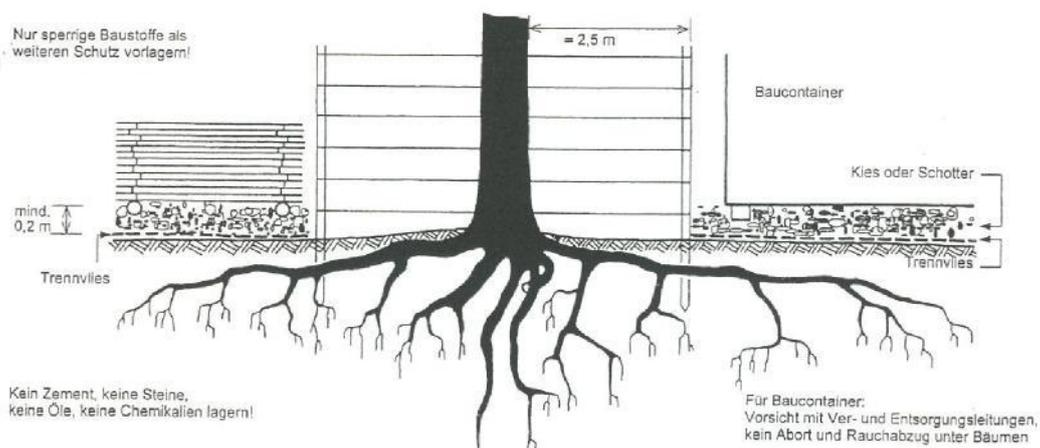
**Bild 3 Wurzeltellerschutz und Stammschutz mit Schutzmanschetten**
