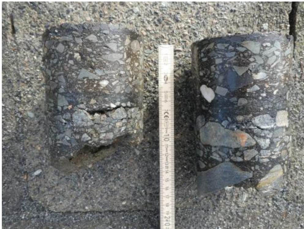
Foto 7: Asphaltbohrkerne BP 07 (d=11 cm) und BP 07-DPH (d=15 cm)
