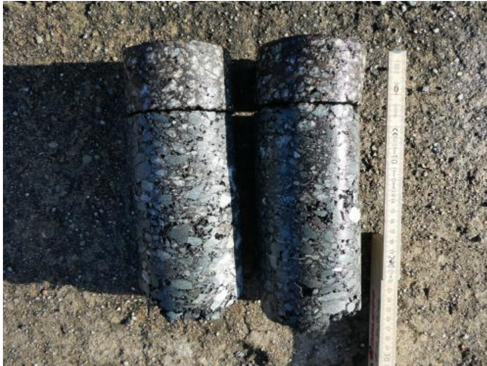
Foto 9: Asphaltbohrkerne BP 09 (d=22 cm) und BP 09-DPH (d=23 cm)
