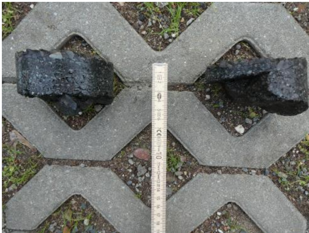
Foto 6: Schulweg, Asphaltbohrkerne BP 06 (d=4cm) und BP 06-DPH (d=5cm)
