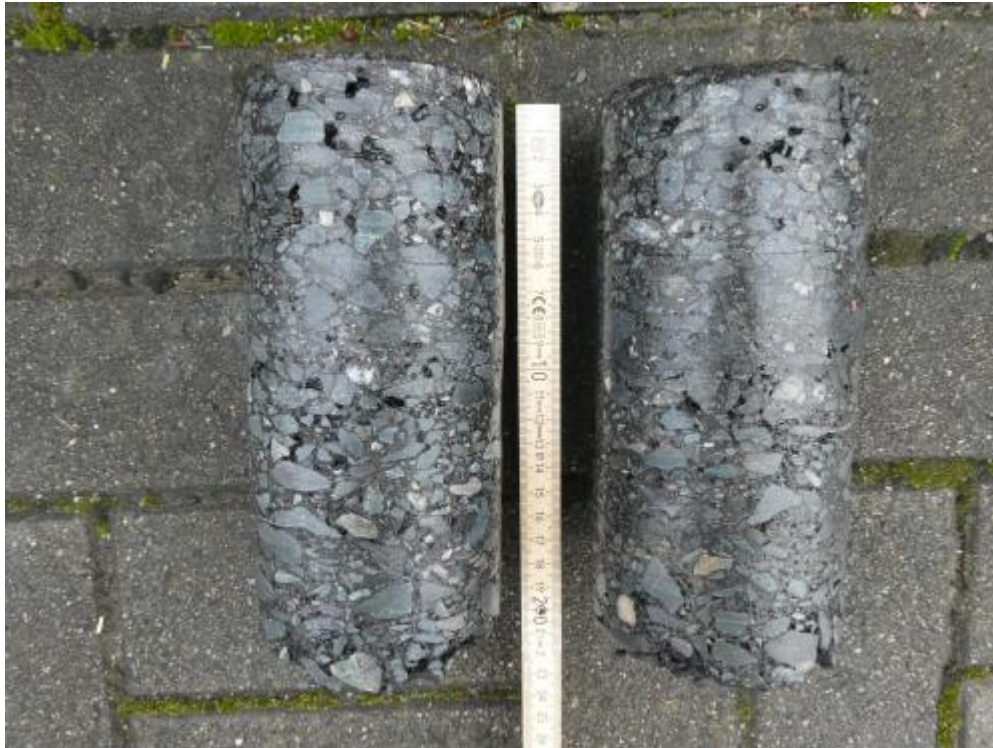
Foto 1: Asphaltbohrkerne BP 01 (d=20 cm) und BP 01-DPH (d=20 cm)
