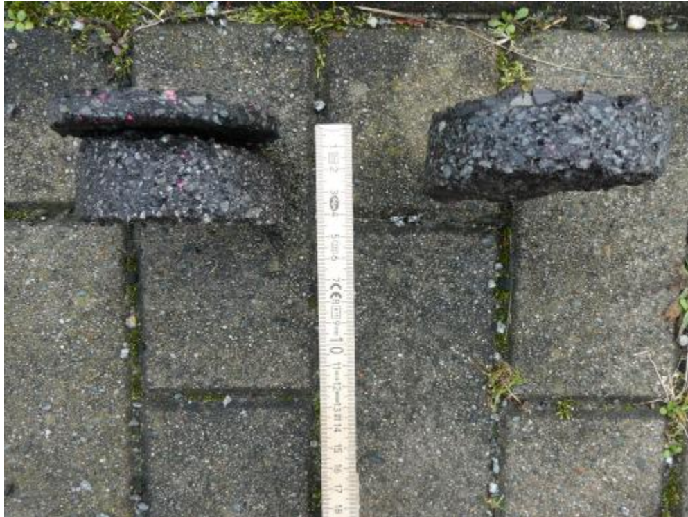
Foto 5: Asphaltbohrkerne BP 05 (d=4cm) und BP 05-DPH (d=3 cm)
