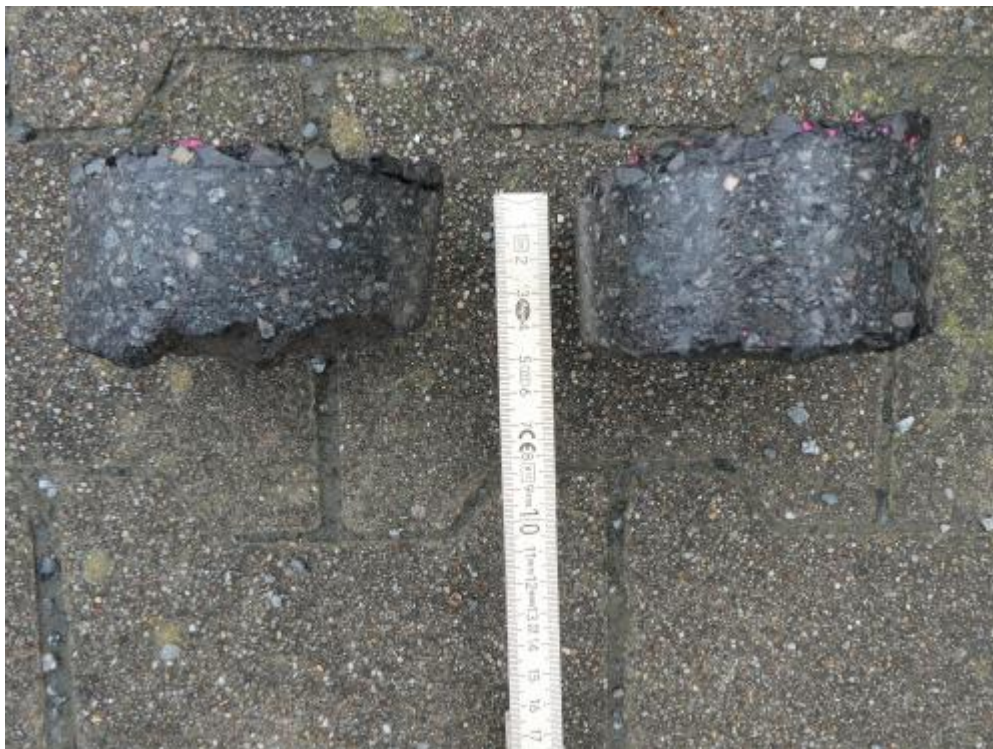
Foto 2: Asphaltbohrkerne BP 02 (d=4cm) und BP 02-DPH (d=5 cm)
