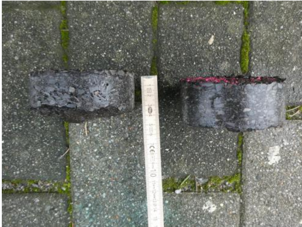
Foto 3: Asphaltbohrkerne BP 03 (d=4 cm) und BP 03-DPH (d=4cm)
