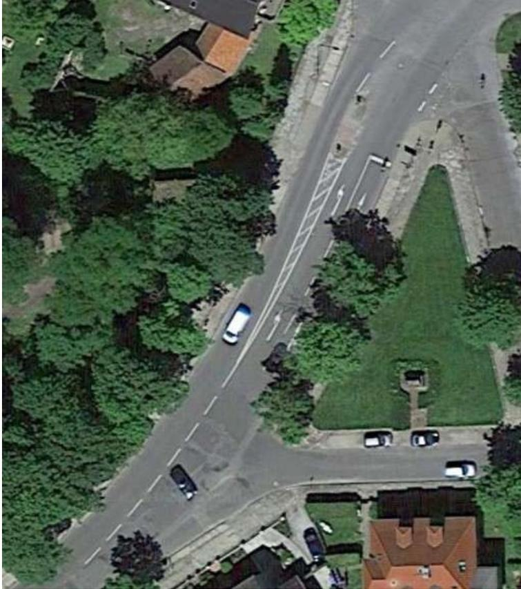
Am Knotenpunkt zu Auf dem hohen Felde wird eine Wartelinie sowie eine unterbrochene Fahrbahnbegrenzung entsprechend der Altmarkierung markiert.
