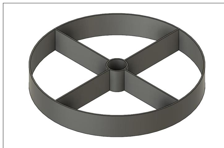
**Diese Abbildung stellt die Halterung der Stangen, für die Verkehrsleitkegel dar.**
