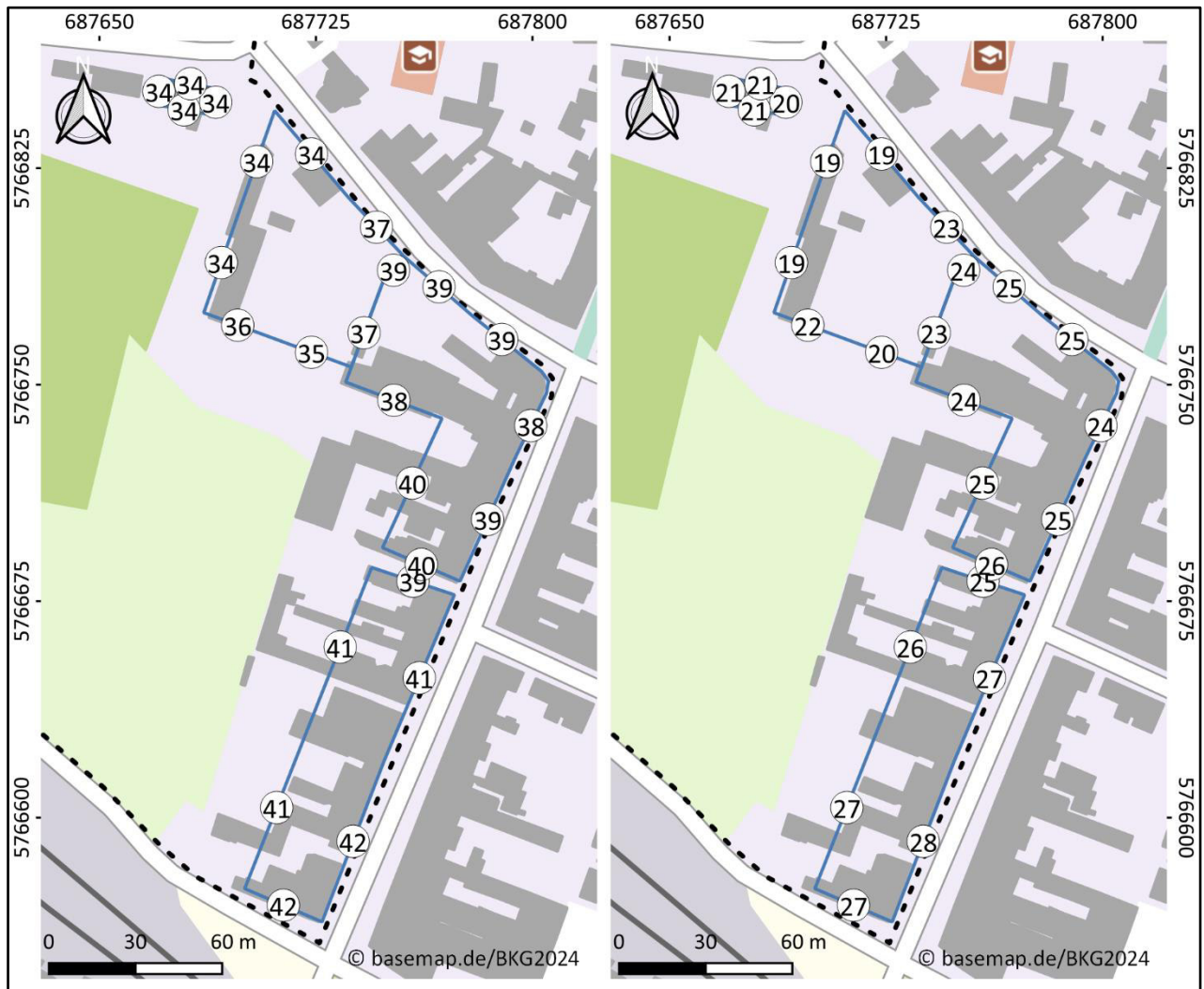
Abbildung 8: Beurteilungspegel Tag (links) und Nacht (rechts) des Gewerbelärms, 1. Obergeschoss (Höhe 5 m)
