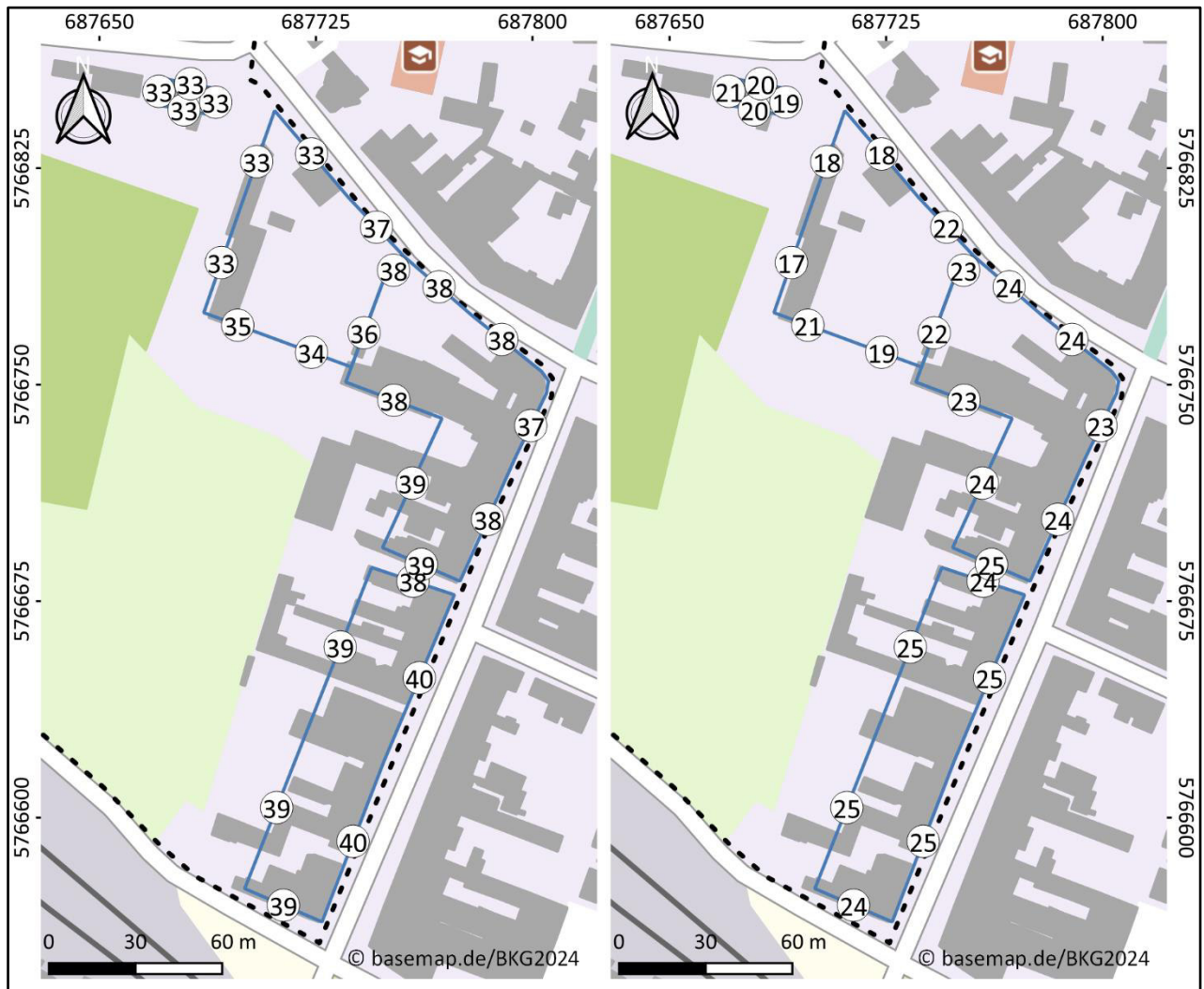
Abbildung 7: Beurteilungspegel Tag (links) und Nacht (rechts) des Gewerbelärms, Erdgeschoss (Höhe 2 m)
