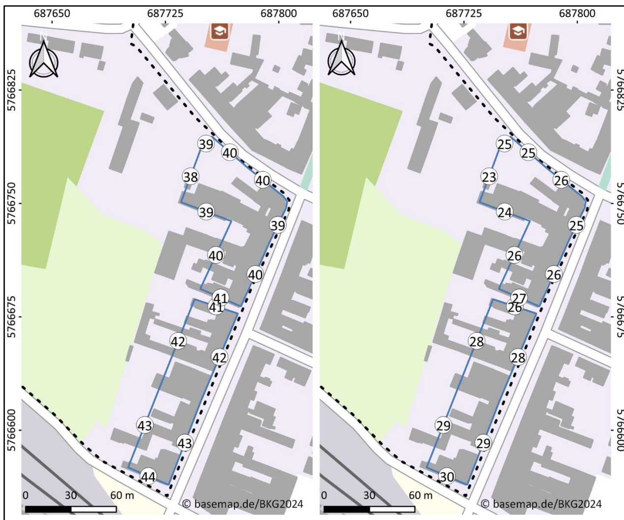
Abbildung 9: Beurteilungspegel Tag (links) und Nacht (rechts) des Gewerbelärms, 2. Obergeschoss (Höhe 8 m)
