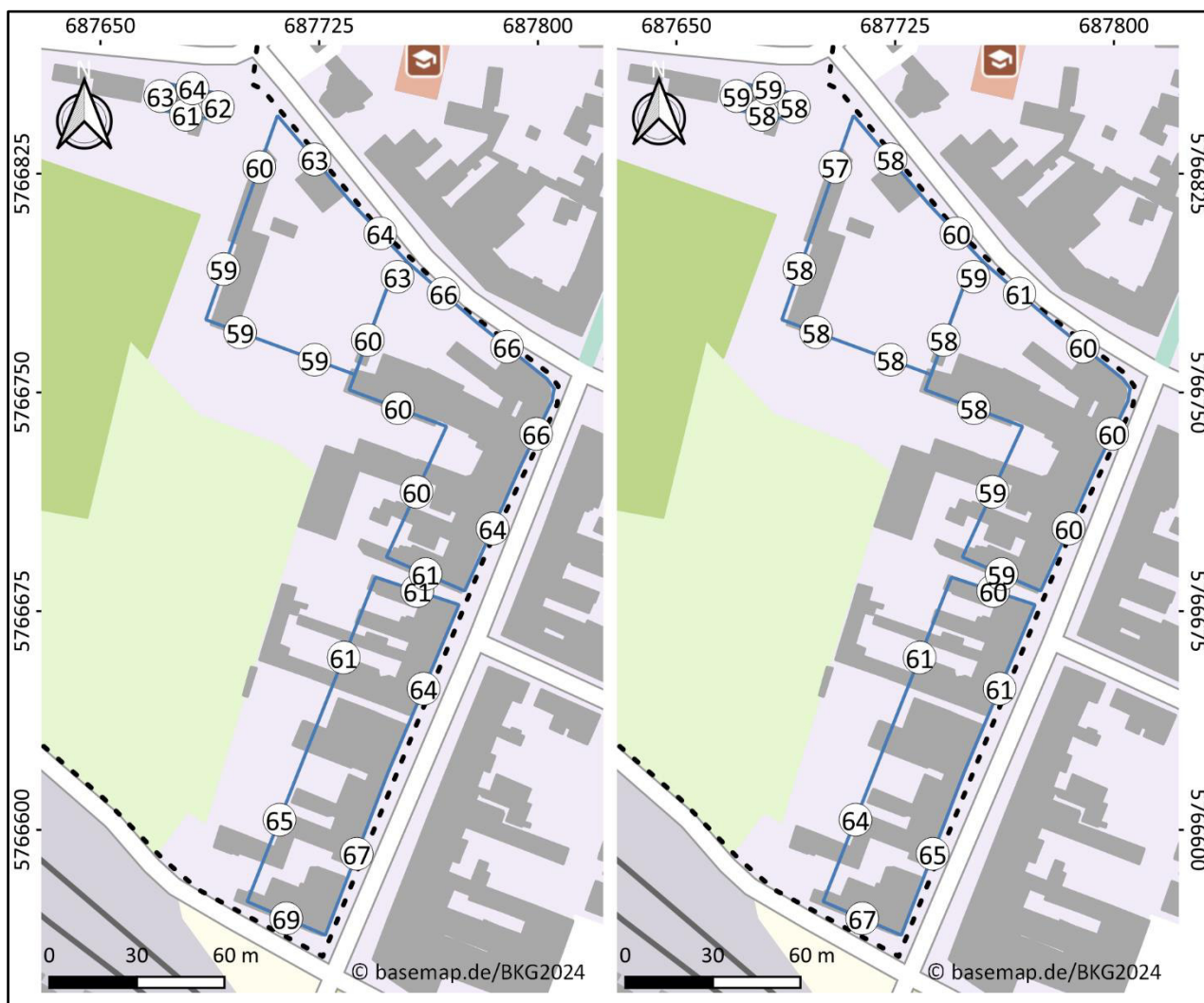
Abbildung 10: Beurteilungspegel Tag (links) und Nacht (rechts) des Verkehrslärms, Erdgeschoss (Höhe 2 m)
