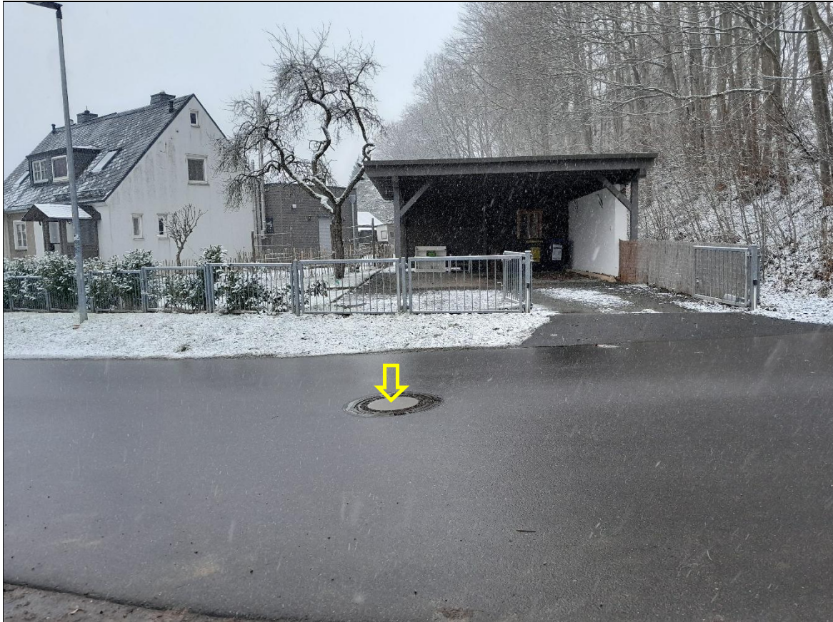
Höhenbezugspunkt (HP1) / OK Deckel = 345,99 m
