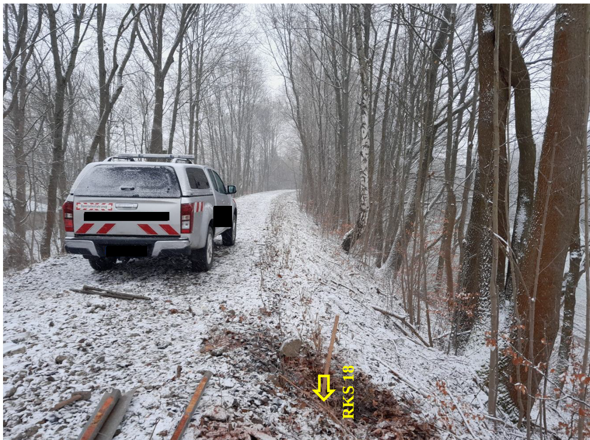
Rammkernsondierung (RKS) 18 – Ansatzpunkt
