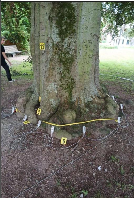
**Abb. 4.2-16:** Impulstomographie-Messkette am Stammfuß (2/2)
