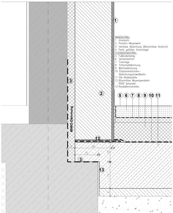
Variante unterer Wandansluß, Trennfuge zum Bestand / Bodenplatte
